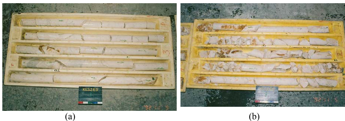
3-11. ábra. Egy ép (a) és egy nagyon töredezett (b) kőzettest magládája
